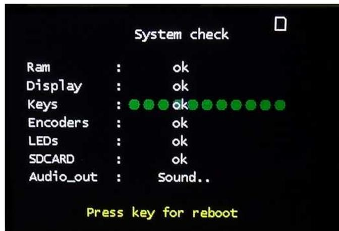
Die Firmware im DE-GENERATOR besitzt einen eingebauten System Test. Damit wird die grundlegende Hardware zB der Sample Speicher, Display, Led's, Tasten, Datenregler, SD Karte und Audioausgabe getestet.
