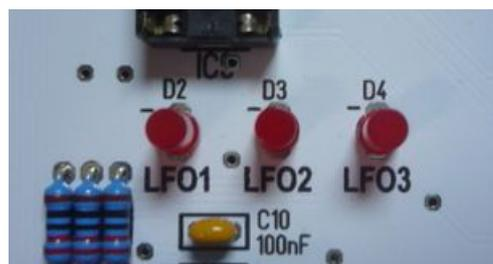
Achtung , wir benutzen rote LEDs für den De-Generator mit einem Plexiglas-Case, da diese nicht so hell sind. R18,19,20,21 werden dann von 330 Ohm auf 220 Ohm abgeändert .
