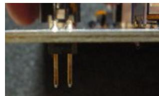
K3,K4 ist die Verbindung zum CPU board und sollte so aussehen
